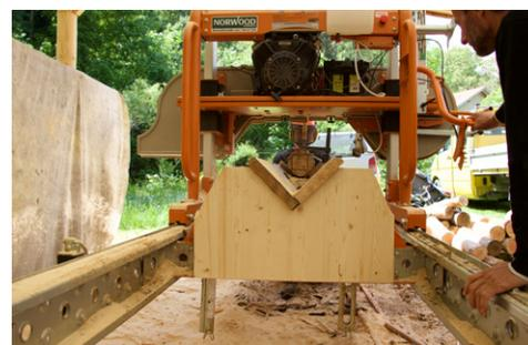
↑ Sciage des éléments à la scie à ruban, après la construction d'un support adapté
